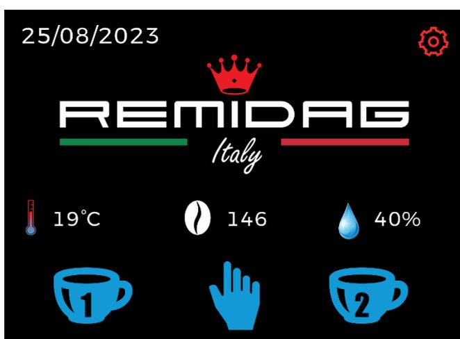
Per regolare il tempo di erogazione relativo alla dose singola, doppia e tripla è necessario accedere alle IMPOSTAZIONI premendo l'ingranaggio rosso in alto a destra dello schermo. Una volta all'interno del menù impostazioni è semplice spostarsi all'interno dello stesso tramite le due frecce ai lati dello schermo.
